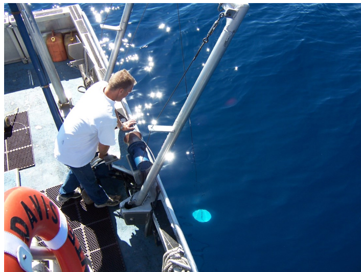
Capitán de barca Brant Allen midiendo la profundidad de Secchi en Lago Tahoe.
